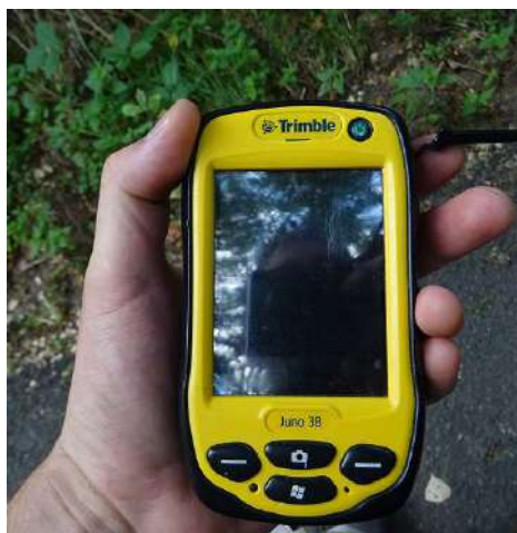
Illustration 14 : Trimble Juno 3B avec le logiciel Cartopocket (Source : Géonat)
