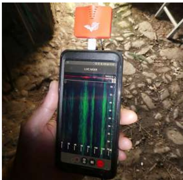
Illustration 74 : EMT2 Pro et LG G-6, utilisé lors des prospections nocturnes chiroptères (Source : Oxalis SCOP)
